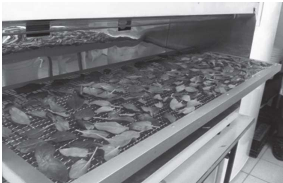
Figura 1. Imagen de una cámara para irradiación UV-C a escala piloto (Centro de Estudios Poscosecha-Universidad de Chile).
